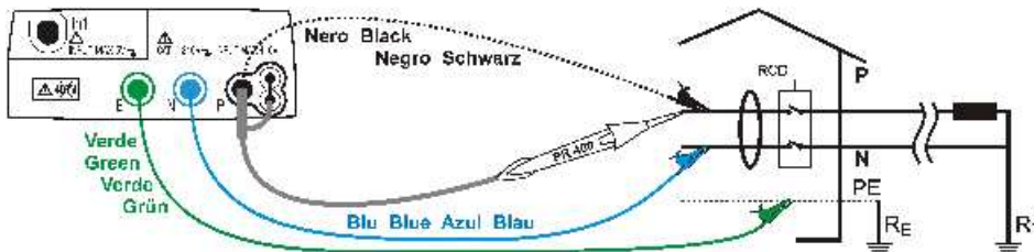
Abb. 5: Geräteanschluss mit Einzelkabeln und Start/Stop Tastkopf PR400
